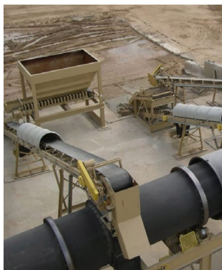
АБЗ непрерывного цикла перемешивания в РФ, оборудованный для производства АБС с возможностью применения до 35% RAP (фото Е.Л. Дамье)[2]
