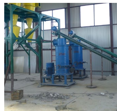
Турбовихревой помольный комплекс ТВК-45 компании «Заря», входящей в ГК «ИНОТЭК»:
